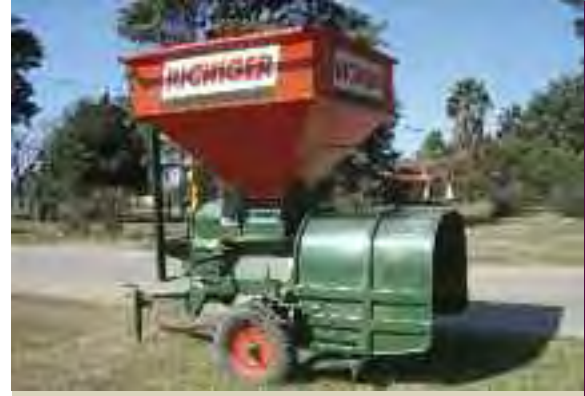
1993 | EMBOLSADORAS - QUEBRADORA PARA EMBOLSADO DE GRANO DE MAÍZ Y SORGO DE ALTO CONTENIDO DE HUMEDAD | BOLSAS DE 6 PIES, 60 TON
