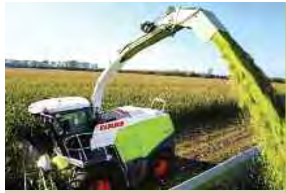
2007 | CONSOLIDACIÓN DEFINITIVA DEL PICADO DE MAÍZ CON PICADORAS AUTO-PROPULSADAS CON CABEZAL ROTATIVO QUEBRADORES DE GRANOS Y MÁS DE 500 CV EN EL MOTOR | 70 MÁQUINAS EN EL MERCADO
