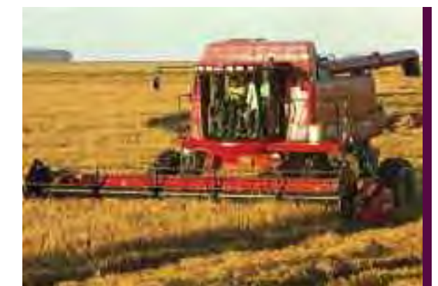
FOTOG. 14 | COSECHADORA ESPECÍFICA ARROCERA DE TRILLA Y SEPARACIÓN AXIAL
