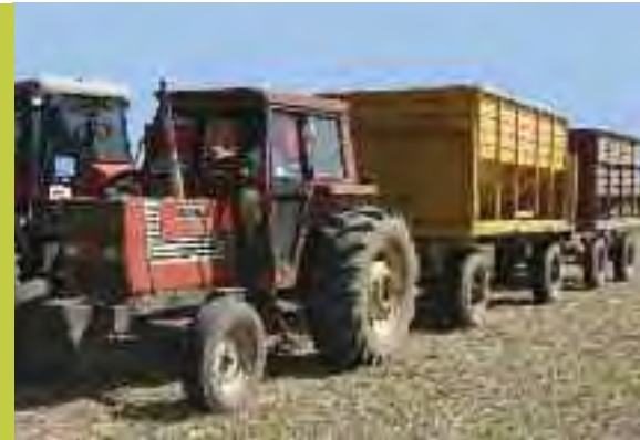
DESDE 1960 HASTA 1985 | ACOPLADOS TOLVA CON DESCARGA POR GRAVEDAD DE 8 Y 6 TONELADAS | SE UTILIZARON MASIVAMENTE
