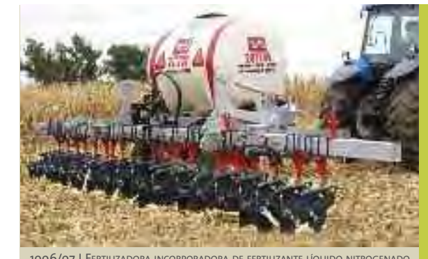
1996/97 | FERTILIZADORA INCORPORADORA DE FERTILIZANTE LÍQUIDO NITROGENADO (UAN) | BOMBA DE PISTÓN DE CAUDAL VARIABLE | VARIOS FABRICANTES ARGENTINOS: VHB, METALFOR Y JURI, ENTRE OTROS
