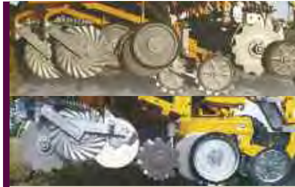
2002 | TODOS LOS FABRICANTES DE SEMBRADORAS EN ARGENTINA INTRODUCEN LA DOBLE FERTILIZACIÓN EN LA SEMBRADORA GRANO FINO Y GRUESO, RESPECTIVAMENTE, COMO SE MUESTRA EN LA FIGURA
