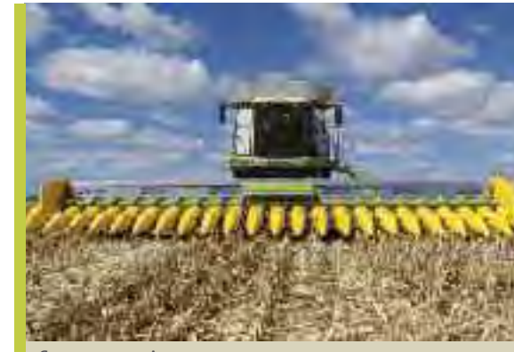
CABEZAL MAICERO ALLOCHIS DE 22 HILERAS A 52 CM, CON BASTIDOR DE ALUMINIO, PUNTON Y CAPOT DE PLÁSTICO | CABEZALES QUE SE EXPORTAN A MÁS DE 10 PAÍSES DEL MUNDO
