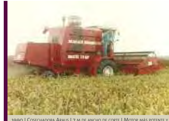
1990 | COSECHADORA ARAUS 17 M DE ANCHO DE CORTE | MOTOR MÁS POTENTE Y MAYOR CAPACIDAD DE TOLVA
