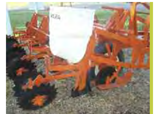
SEMBRADORA MIGRA PARA SIEMBRA DIRECTA UTILIZADA EN LOS ENSAYOS DE LABRANZA DE LARGA DURACIÓN DESDE EL AÑO 1976 EN LA ESTACIÓN EXPERIMENTAL AGROPECUARIA INTA MARCOS JUÁREZ | CUCHILLA DE CORTE CON PATÍN LIMITADOR DE PROFUNDIDAD, AZADÓN CON QUILLA DE SUCCIÓN, RUEDA APRETADORA DE SEMILLA Y DOBLE DISCO ESCOTADO COMO TAPADOR | DISTRIBUIDOR DE SEMILLA CON PLACA INCLINADA, UN HITO PARA LA SIEMBRA DIRECTA EN GRANO GRUESO
