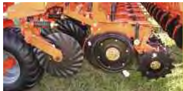
1996 | APARICIÓN DE LA CUCHILLA TURBO DE CORTE Y REMOCIÓN
