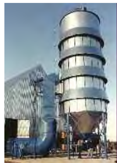
1993 | SECADORA DE FLUJO CONTINUO, PARA MANÍ EN VAINA Y ARROZ EN CÁSCARA
