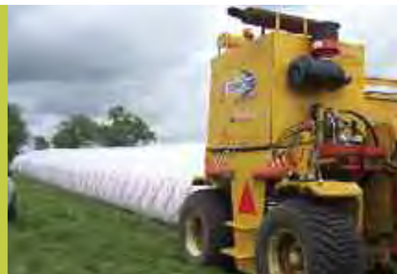
2005: APARICIÓN DE LAS EMBOLSADORAS DE 9 Y 10 PIE CON MOTOR PROPIO Y SISTEMA AUTOPROPULSADO HIDROSTÁTICO
