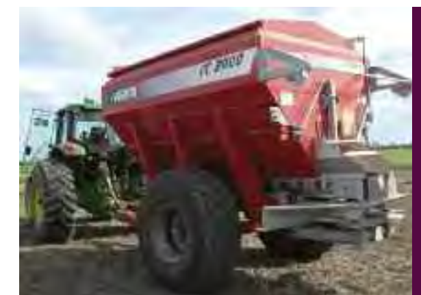
2003 | FERTILIZADORA AL VOLEO CON DOBLE PLATO Y ALIMENTACIÓN POR CINTA DE VELOCIDAD VARIABLE PARA TASA VARIABLE (VRT) | CAPACIDAD DE TOLVA: 5.000 LTS | EMPRESA FÉRTIL
