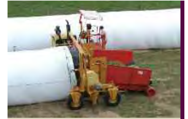
1999 | EMBOLSADORAS DE 9 PIE, FABRICADO EN ARGENTINA, CON MOTOR PROPIO Y DESCARGA FRONTAL.
