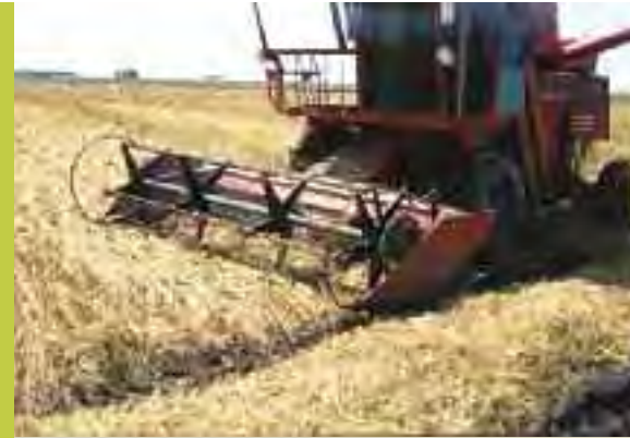
FOTOG. 6 | LAS PRIMERAS COSECHADORAS CON CABINA MODIFICADAS POR TALLERES LOCALES INCORPORÁNDOLE TRACCIÓN EN EL EJE TRASERO
