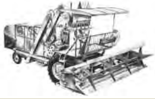
1954 | COSECHADORA SÚPER VASSALLI | CABEZAL DE 16 PIES DE ANCHO | BARRA DE CORTE RÍGIDA, CON MANDO DE CUCHILLA POR BALANCÍN | SINFIN FLOTANTE | MOLINETE DE 5 PALAS FIJAS | MOTOR PERKINS (4 CILINDROS), APROX. 75 CV. EQUIPADA CON BOLSERO MANUAL PARA BOLSAS DE 50 KG
