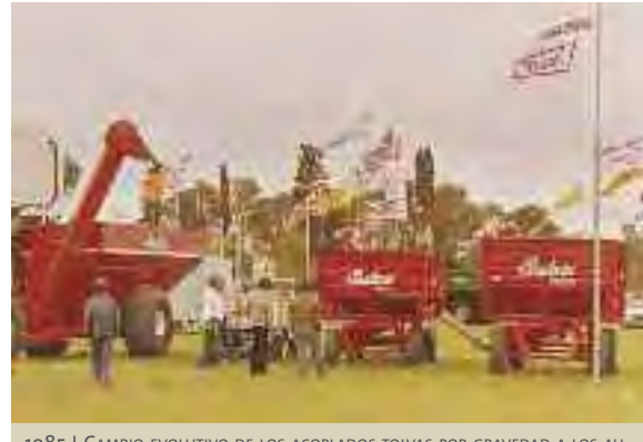
1985 | CAMBIO EVOLUTIVO DE LOS ACOPLADOS TOLVAS POR GRAVEDAD A LOS AUTODESCARGABLES CON TDP | FACILIDAD DE MOVIMIENTO DEL GRANO DESDE LA TOLVA AL CAMIÓN Y MAYOR CAPACIDAD DE CARGA
