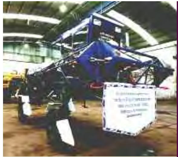
1974 | PRIMER PULVERIZADOR AUTOPROPULSADO PLA | MOTOR NAFTERO, SUSPENSIÓN DELANTERA INDEPENDIENTE, TANQUE DE 1600 LITROS DE CAPACIDAD, 20,3 M DE ANCHO DE BARRAL | COMIENZOS DE UN CAMBIO DE PARADIGMA EN LA APLICACIÓN DE AGROQUÍMICOS EN ARGENTINA | PAULATINAMENTE ESTAS MÁQUINAS FUERON CRECIENDO EN SU ADOPCIÓN SOBRE LA APLICACIÓN CON PULVERIZADORES DE ARRASTRE Y LA APLICACIÓN AÉREA.
