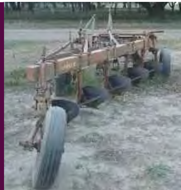
DÉCADA DEL '80 | ARADO DE 5 REJAS GHERARDI CARACTERÍSTICOS DE LA LABRANZA PRIMARIA | DEMANDA DE POTENCIA DE 60 CV | POSTERIORMENTE, ESTOS ARADOS FUERON CRECIENDO EN TAMAÑO, LLEGANDO AL AÑO 1989 A FABRICARSE ARADOS DE REJAS EN ARGENTINA DE 22 CUERPOS | CON DEMANDA DE POTENCIA DE 300 CV
