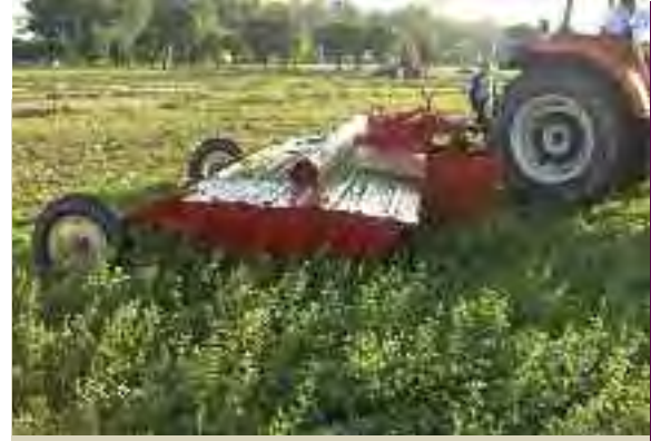
CORTADORA TIPO DOBLE HÉLICE DE 2,80 M DE ANCHO. TDP DEL TRACTOR 530 RPM | SU USO SE EXTENDIÓ DESDE 1965 HASTA LA ACTUALIDAD
