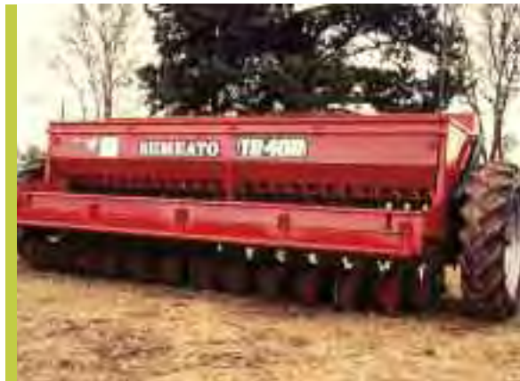
1989/90 | SEMBRADORA SEMEATO | GRANO FINO TRIGO/PASTURAS CON FERTILIZACIÓN EN LÍNEA
