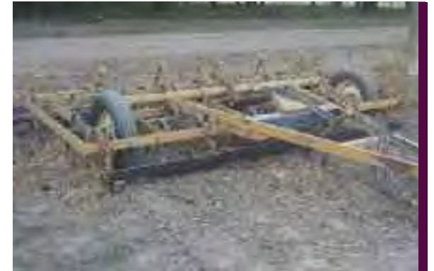
1985 | DIFUSIÓN DEL VIBROCULTIVADOR PARA PREPARACIÓN DE CAMA DE SIEMBRA, RABASTO NIVELADOR, BRAZOS EN "S" VIBRADORES Y ROLLO DESTERCONADOR
