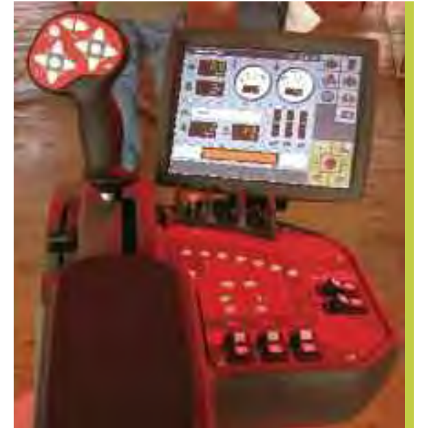
2008 | TABLERO ELECTRÓNICO VASSALLI AXIAL AX 7500 | ALTO DESARROLLO TECNOLÓGICO, MONITOR DE RENDIMIENTO, JOYSTICK DE COMANDO CENTRALIZADO, PANTALLA DE CUARZO LÍQUIDO ACTIVA | TODO ELLO POSIBILITÓ VENDER LA PATENTE DE ESTA COSECHADORA A SAME DEUTZ FAHR
