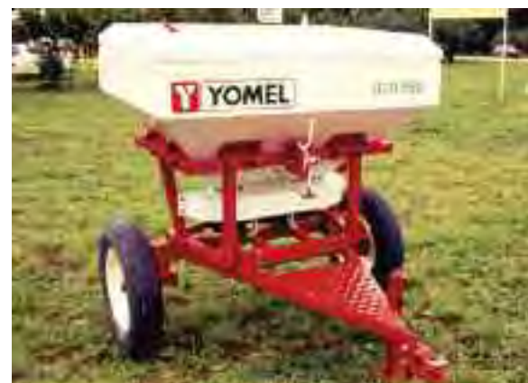
1990 | FERTILIZADORA ESPARCIDORA DE DOBLE PLATO CENTRÍFUGO PARA DISTRIBUIR FERTILIZANTE AL VOLEO | CAPAC. DE TOLVA 850 KG, 20 M DE ANCHO DE LABOR | YOMEL | ÉSTAS MÁQUINAS TAMBIÉN SE UTILIZARON PARA SIEMBRA DE PASTURAS AL VOLEO
