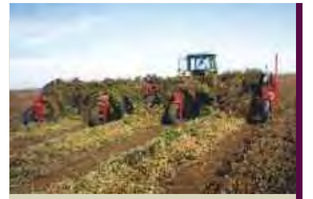
2002 | PRIMERAS ARRANCADORAS - INVERTIDOTAS DE MANÍ DE 12 X 3. MAYOR CAPACIDAD DE TRABAJO, TRACTORES DE 180 CV
