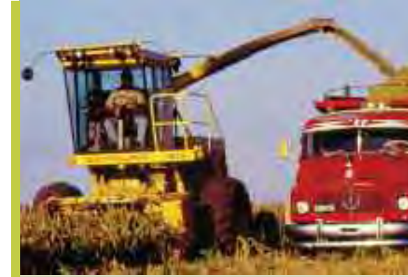
1985 | PRIMERAS PICADORAS DE PICADO FINO AUTOPROPULSADAS PARA MAÍZ, SORGO Y PASTURAS. 270 HP | CABEZAL DE 4 HILERAS PARA MAÍZ | UNA REVOLUCIÓN EN CAPACIDAD Y CALIDAD DE PICADO FINO
