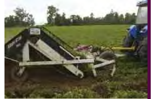
1987/88 | PRIMERAS ARRANCADORAS - INVERTIDOTAS DE MANÍ DE 4 X 1. CAMBIO TECNOLÓGICO FUNDAMENTAL PARA LA OBTENCIÓN DE CALIDAD DE MANÍ CONFITERÍA
