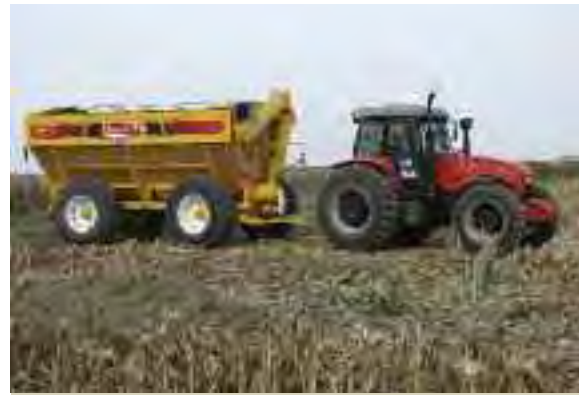
2000 | TOLVA AUTODESCARGABLE DE 17 TONELADAS DE CAPACIDAD DE DOS EJES, EQUIPADA CON BALANZA ELECTRÓNICA
