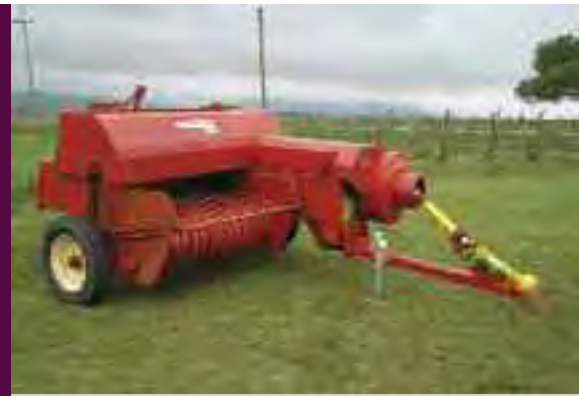
1970 | APARICIÓN DE LA ENFARDADORA PRISMÁTICA EN ARGENTINA | ENFARDADORA DE ARRASTRE CON TDP DE 540 RPM, ATADO POR ALAMBRE
