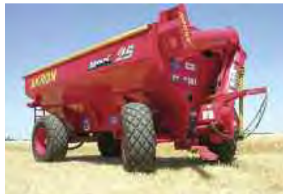
TOLVA AUTODESCARGABLE AKRON MAX 25, DE 25 TON DE CAPACIDAD, DOS EJES, BALANZA ELECTRÓNICA CON TRANSMISIÓN DE DATOS EN TIEMPO REAL
