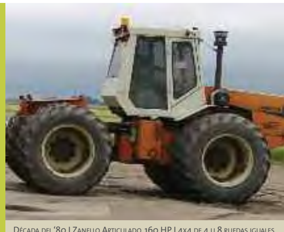
DÉCADA DEL '80 | ZANELLO ARTICULADO, 160 HP | 4x4 DE 4 U 8 RUEDAS IGUALES, GRAN EFICIENCIA TRACTIVA Y EXCELENTE RELACIÓN PRECIO/PRESTACIÓN
