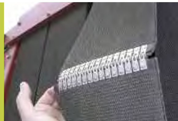
1997 | NUEVA GENERACIÓN DE ROTOENFARDADORAS CON MAYOR PRESIÓN Y DIÁMETRO DE ROLLOS, NUEVAS CORREAS DE MAYOR RESISTENCIA Y NUEVAS UNIONES DE MAYOR RESISTENCIA
