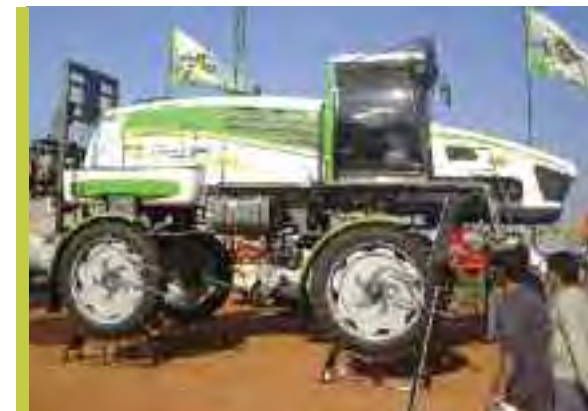
2007 | PULVERIZADORA AUTOPROPULSADA METALFOR DE ÚLTIMA GENERACIÓN CON MOTOR DELANTERO, SUSPENSIÓN NEUMÁTICA, BARRAL DE MÁS DE 30 M, COMPUTADORA INTERACTIVA PARA DOSIS VARIABLE, CASILLA METEOROLÓGICA Y AUTOGUÍA
