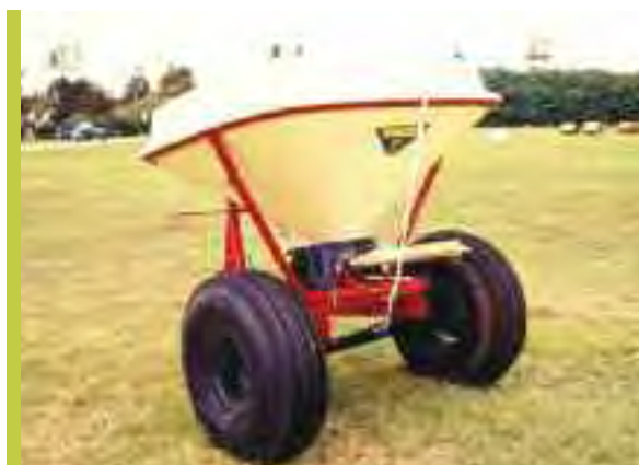
1980 | FERTILIZADORA ESPARCIDORA AL VOLEO PENDULAR CON TOLVA DE 800 KG DE CAPAC. | DISTRIBUCIÓN DE UREA AL VOLEO, GENERALMENTE EN TRIGO AL MACOLLAJE | TANZI
