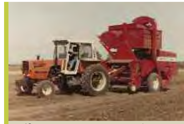
1995 | PRIMERAS COSECHADORAS - DESCAPOTADOTAS DE MANÍ CONSTRUIDAS EN ARGENTINA CON SISTEMA DE MULTICILINDRO DE DIENTES FLEXIBLES Y ALMACENAJE A GRANTEL CON TOLVAS DE DESCARGA POR GRAVEDAD
