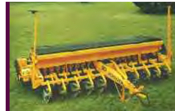
1990 | AGROMETAL GX CUCHILLA INCLINADA PARA LOCALIZAR EL FERTILIZANTE DURANTE LA SIEMBRA | MONOAMÓNICO Y DIAMÓNICO EN TRIGO Y PASTURAS
