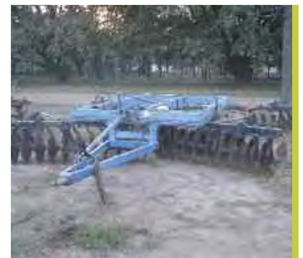
1987 | RASTRA DE DISCOS DE PAQUETES DESENCONRADOS, GRAN DIFUSIÓN | PREPARACIÓN DE CAMA DE SIEMBRA, INCORPORACIÓN DE HERBICIDA DE PRESIEMBRA Y CON CAJÓN SEMBRADOR, SE UTILIZÓ PARA SIEMBRA DE TRIGO Y VERDEOS DE INVIERNO Y VERANO
