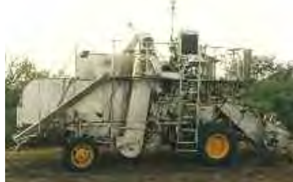
1960 | COSECHADORA - DESCAPOTADORA DE MANÍ, CON ALMACENAJE EN BOLSONES DE ARPILLERA
