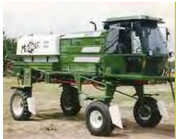
1985 | PULVERIZADORA AUTOPROPULSADA METALFOR | 24 M DE ANCHO, TANQUE DE 2500 LITROS, MOTOR DE 120 CV | COMPUTADORA ELEMENTAL
