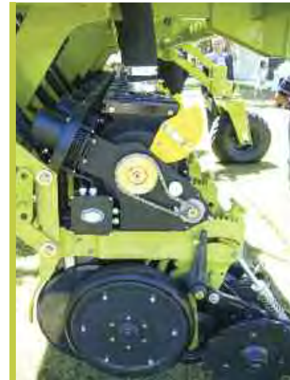
2009 | SEMBRADORA DE GRANO GRUESO NEUMÁTICA SCHIARRRE CON MOTOR ELÉCTRICO DE ACCIONAMIENTO DE TURBINA Y MOTOR ELÉCTRICO DE MANDO CINEMÁTICO EN CADA CUERPO. DOSIS VARIABLE DE SEMILLA Y FERTILIZANTE, SISTEMA CAN BUS, TODO ACCIONADO ELÉCTRICAMENTE
