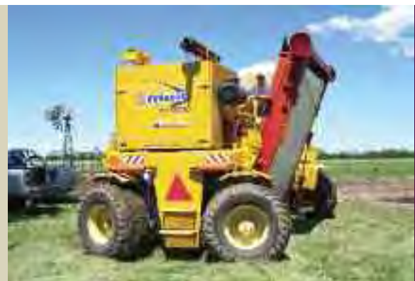
2005: APARICIÓN DE LAS EMBOLSADORAS DE 9 Y 10 PIE CON MOTOR PROPIO Y SISTEMA AUTOPROPULSADO HIDROSTÁTICO
