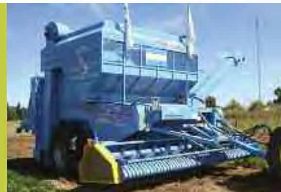
2005 | COSECHADORA - DESCAPOTADORA DE MANÍ MULTICILÍNDRICA 8 X 2, CON TOLVA DESCARGA POR CINTA
