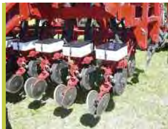
2002 | TREN DE SIEMBRA DE GRANO FINO/GRUESO CON SIEMBRA MONOGRANO DE SOJA
