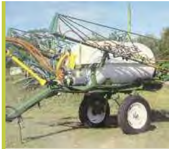
1971 | PULVERIZADORA DE ARRASTRE METALFOR DE 2000 LITROS, BARRAL DE 18 M
