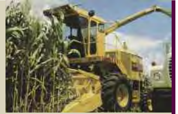
1985 | PRIMERAS PICADORAS DE PICADO FINO AUTOPROPULSADAS PARA MAÍZ, SORGO Y PASTURAS. 270 HP | CABEZAL DE 4 HILERAS PARA MAÍZ | UNA REVOLUCIÓN EN CAPACIDAD Y CALIDAD DE PICADO FINO
