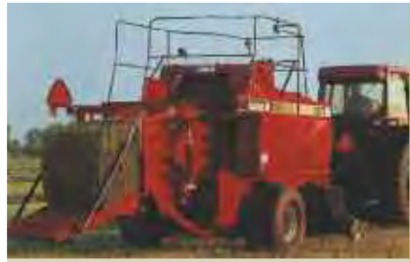
1997-98 | ENFARDADORA PRISMÁTICA GIGANTE, FARDO DE 500 KG | EN 1997 EL INTA PROPEFO REALIZA UN ENSAYO COMPARATIVO ENTRE UNA ROTOENFARDADORA Y UNA ENFARDADORA GIGANTE (VENTAJAS A FAVOR DEL FARDO GIGANTE, POR CALIDAD Y CAPACIDAD DE TRABAJO)
