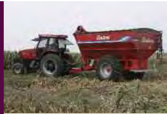
DÉCADA DEL '90 | ACOPLADOS TOLVA AUTODESCARGABLES | 14 TONELADAS, UN EJE, EQUIPADO CON BALANZA ELECTRÓNICA
