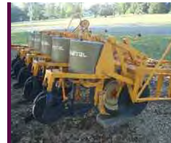
SEMBRADORA AGROMETAL T-5 PARA SIEMBRA DIRECTA, UTILIZADA EN LOS ENSAYOS DE LARGA DURACIÓN DESDE EL AÑO 1974 EN LA ESTACIÓN EXPERIMENTAL AGROPECUARIA INTA MARCOS JUÁREZ | CUCHILLA DE CORTE, UNA REJA, AZADÓN, RUEDA APRETADORA DE SEMILLA Y AZADAS TAPADORAS
