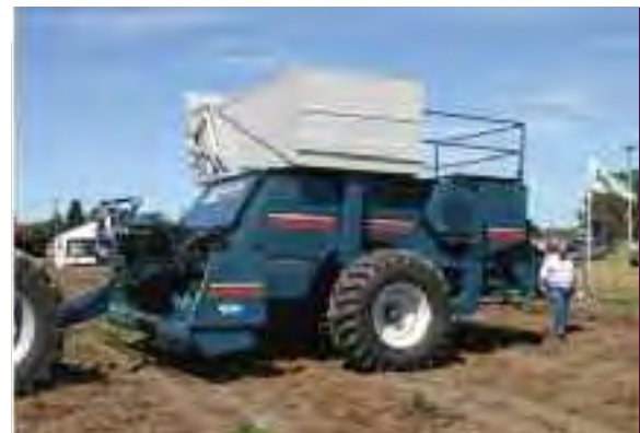
2005 | COSECHADORA - DESCAPOTADOTA DE MANÍ MULTICILÍNDRICA 8 X 2, TOLVA DESCARGA POR GRAVEDAD | FABRICADA POR AGRINAR, BAJO LICENCIA AMADAS DE EE.UU.
