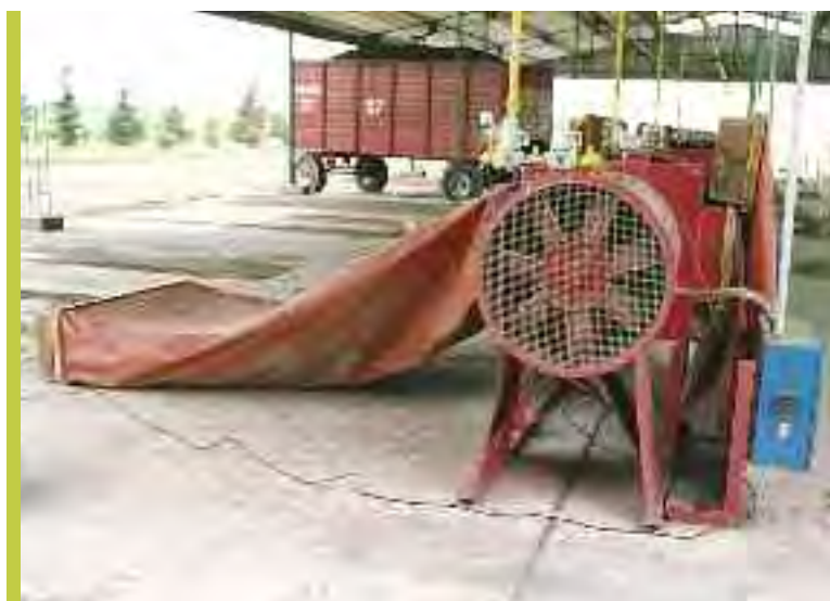
1990 | SECADO ESTACIONARIO | EQUIPO PARA SECADO DE MANÍ EN VAINA CON ACOPLADO TOLVA DE DOBLE PISO, VENTILADOR, QUEMADOR Y TERMOSTATO. UN HITO PARA LA PRODUCCIÓN DE MANÍ CONFITERÍA.
